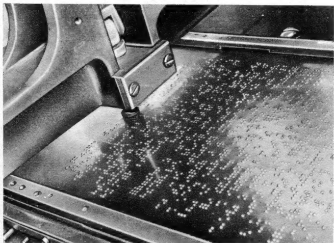
Herstellung einer Blindenzeitschrift. Die Buchstabengruppen werden in eine Zinkplatte eingeppräg. Diese Platte dient dann zum „Drucken“ der eigentlichen Blindenzeitung
