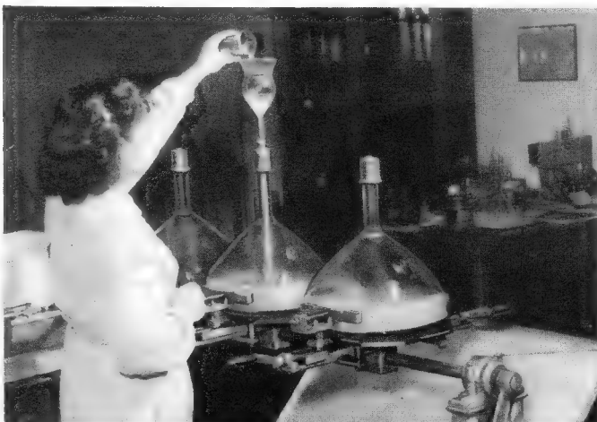
Bild 1. Einfüllen der Leuchtstoffsuspension. Die Einfüllvorrichtung bewirkt eine gute Verteilung der Suspension in der Trägerlösung und sorgt damit für eine gleichmäßige Stärke der Leuchtstoffschicht auf der Schirmfläche nach der Sedimentation (C. Lorenz A. G.)
